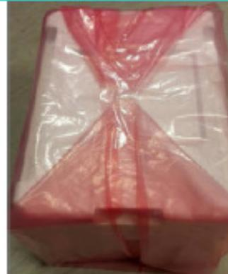
將 EPS box 放入静电袋中, 并用透明胶帶將静电袋封口
