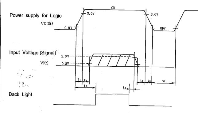
$\begin{array}{c} \underline{\text{POWER ON}} \\ & t_1 \leq 15\,\text{ms} \\ \\ \text{Oms} < t_2 \leq 45\,\text{ms} \\ \\ \text{O. 1s} \leq t_3 \end{array}$
