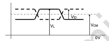
5) V<sub>CM</sub>: LVDS Common mode voltage (V<sub>CM</sub>=1.25V)
