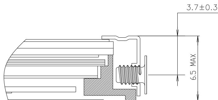
Note) Unit:[mm], General tolerance:  $\pm 0.5\text{mm}$
