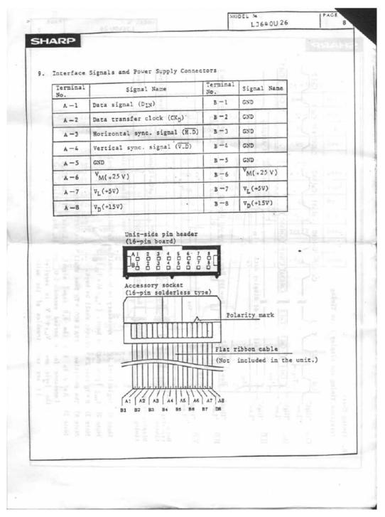
上图是 LJ640U26 的接口定义。The above is the pin assignment of U26 LJ640U35 的 A-8 和 B-8 是悬空的,其他的引脚和 LJ640U26 完全一样。 About LJ640U35,pin A-8 and B-8 are vacant,other pins are the same as LJ640U26
