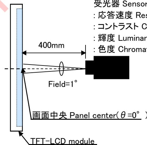
図2-2 コントラスト/輝度/応答速度/色度特性測定方法
